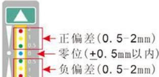
默认显示的是传感器检测出的材料偏差量, 当偏差量在±0.5mm 以内时只点亮中间的“兰色” LED 灯, 当偏差大于 0.5mm 时根据偏差量的大小往正偏差或负偏差方向依次点亮“绿-黄-红” 3 个 LED.
